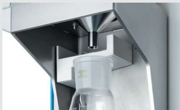
Der programmgesteuerter Tropfensammler sorgt für einen sauberen Labortisch
